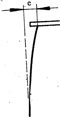
图7 桌面水平耐久性试验位移值测量方法
